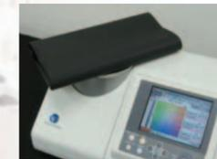
只需把被测样品放置在仪器顶部，即使较大体积的样品也可进行测量。
